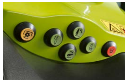
Zewnętrzne elementy obsługowe tylnego podnośnika, WOM i wybranego zaworu hydraulicznego
