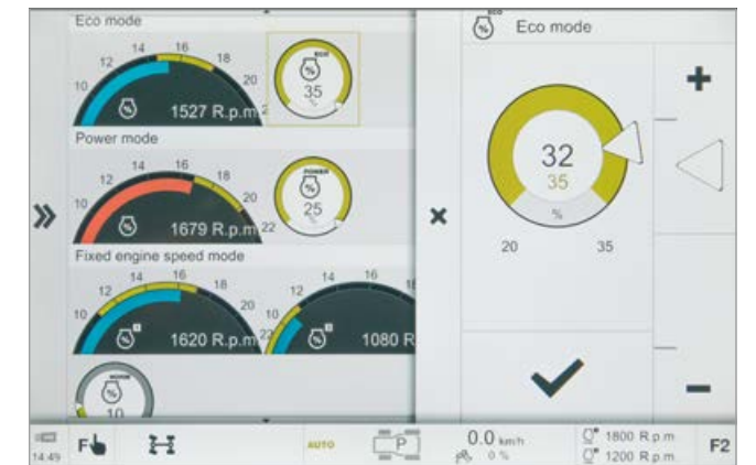
Ustawienie obniżania obrotów silnika dla wartości „Eco” i „Power” oraz pamięci liczby obrotów silnika.
